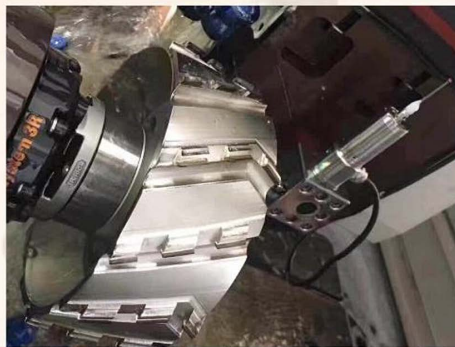
PCD齿侧刃双面同时加工
